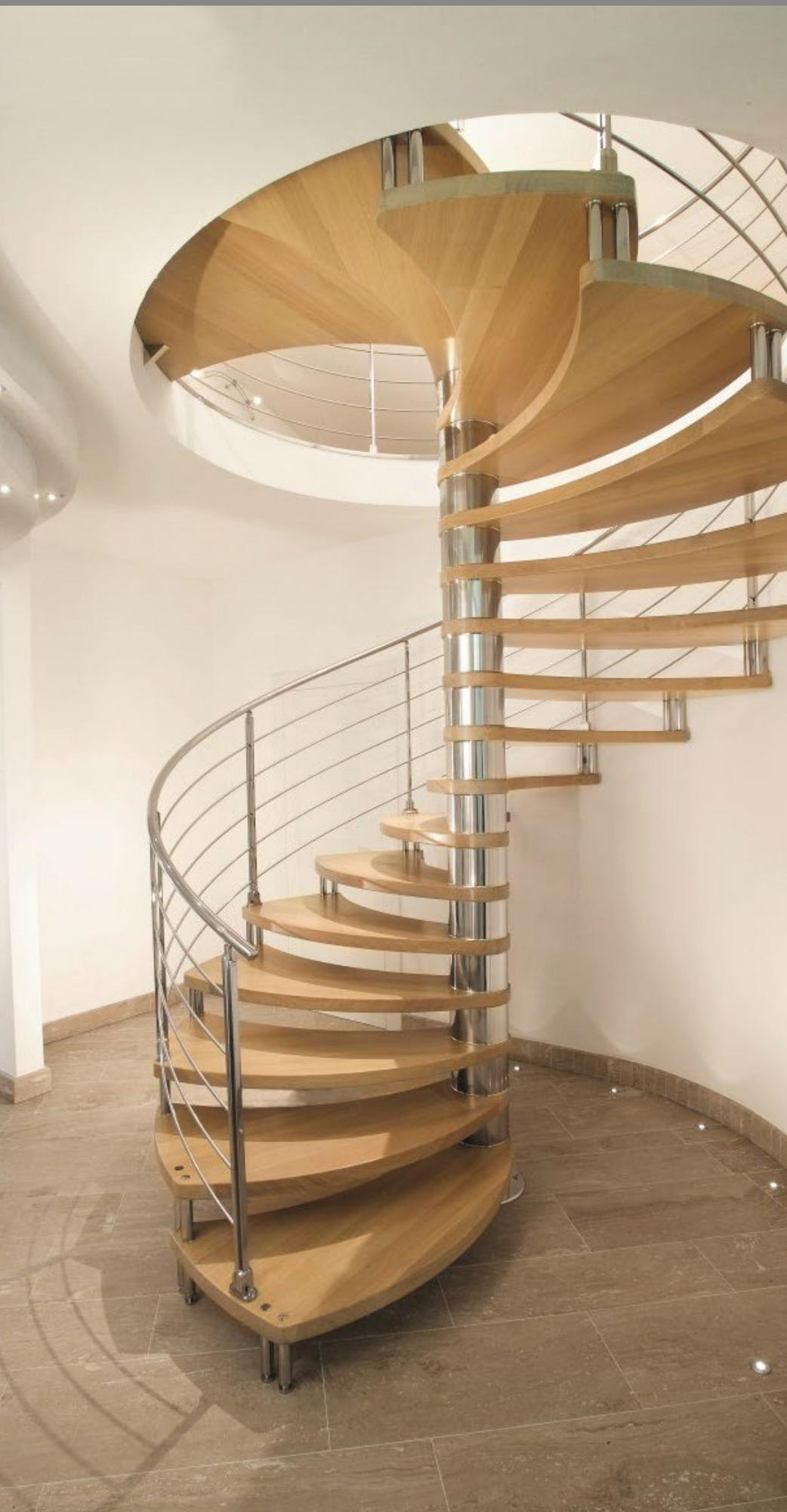
**STRUCTURE** : composée d'un axe central en acier inoxydable avec bagues intercalaires en inox
